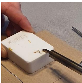
Afbeelding: Voorbeeld van reiniging van de tip van een soldeerbout met een ammoniakteen
