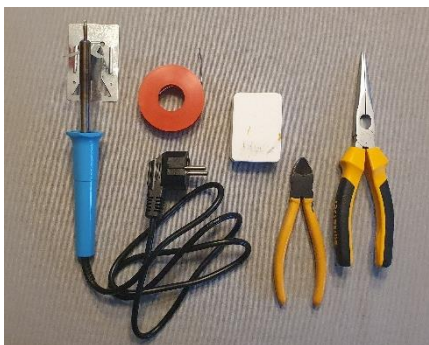
Afbeelding benodigheden voor solderen: voorbeeld van een eenvoudige soldeerbout, soldeersel (tin op bobijn), een ammoniaksteen ter reiniging van de tip van de soldeerbout, een knip- en knijptang.
